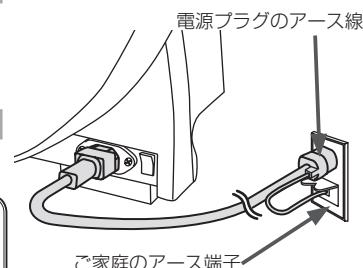
電源コードは、必ず本機器に付属のものをご使用ください。とくに、電源コードのプラグ部にアース線がついていないものは万一の感電を防ぐことができませんので絶対に使用しないでください。
